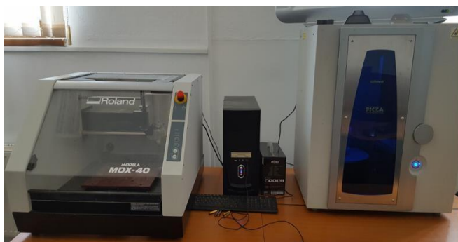
Mașină de prototipaj rapid Roland MODELA MDX-40 și scanner 3D Roland PICZA
